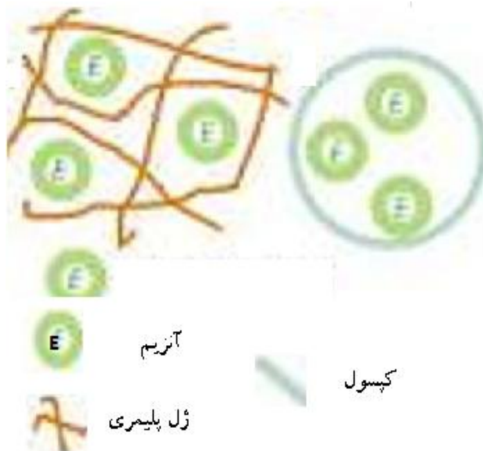
شکل ۴ - به دام افتادن آنزیم در ژل پلیمری غشا یا کپسول
